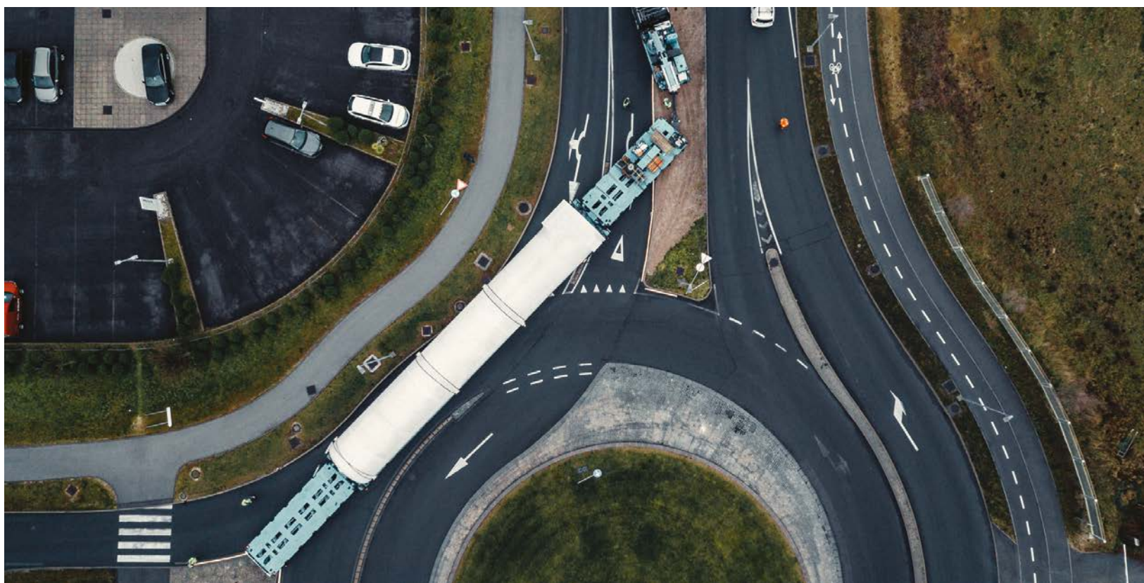
Izredni prevoz izjemnih dimenzij in teže na poti (prikaz premagovanja cestne infrastrukture).
